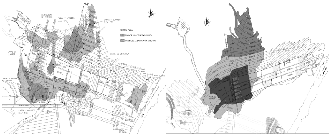
Figura 4.12. Modificación del Vertedor y giro de la presa en la Margen Izquierda del P. H. La Yesca.
