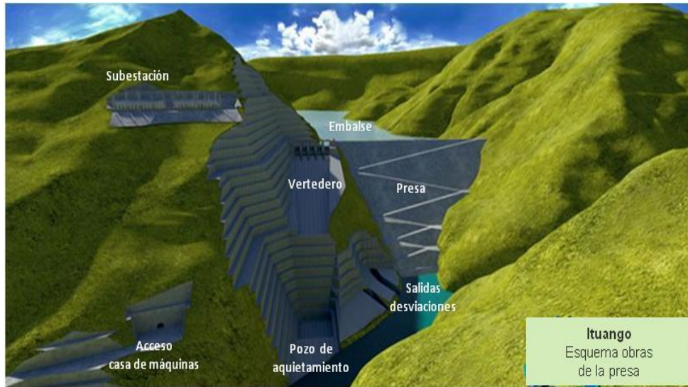
Figura 4.19. Vista de las obras de aguas abajo hacia aguas arriba del P. H. Ituango, Col.
