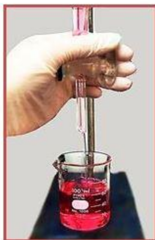
Fig. II.4 Funcionamiento de la llave de la bureta
