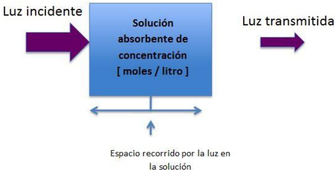
FIGURA 4.2 FENÓMENOS DE ABSORBANCIA Y TRANSMITANCIA
