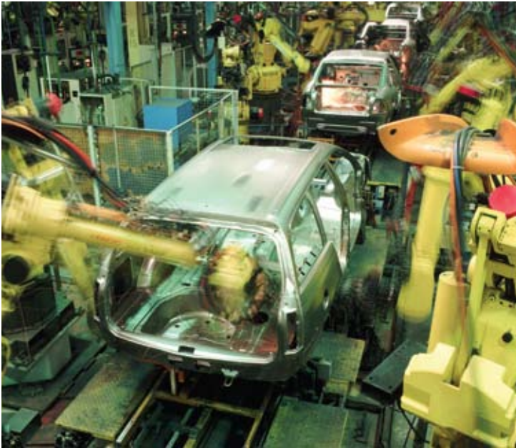
La industria automotriz cada vez utiliza menos trabajadores, quienes son sustituidos por robots. Ensamble de vehículos en una empresa de Alemania | © Latin Stock México.
