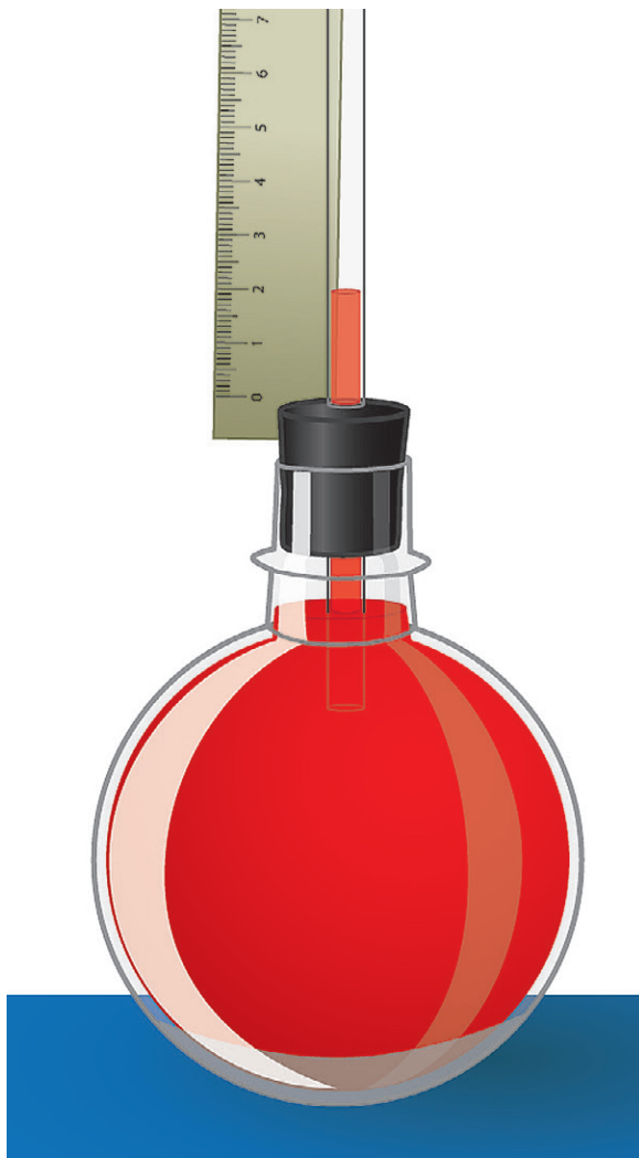
Figura 5. Construcción de un termómetro y escala de temperatura. [Véase video en CD: “Construcción de un termómetro”.]
