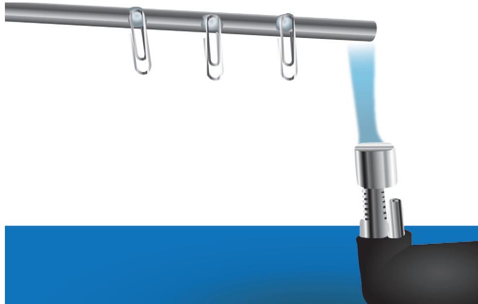
Figura 1. Conducción por calor en una barra de cobre y en una de asbesto. [Véase video en CD: “Conducción de energía por calor.”]
