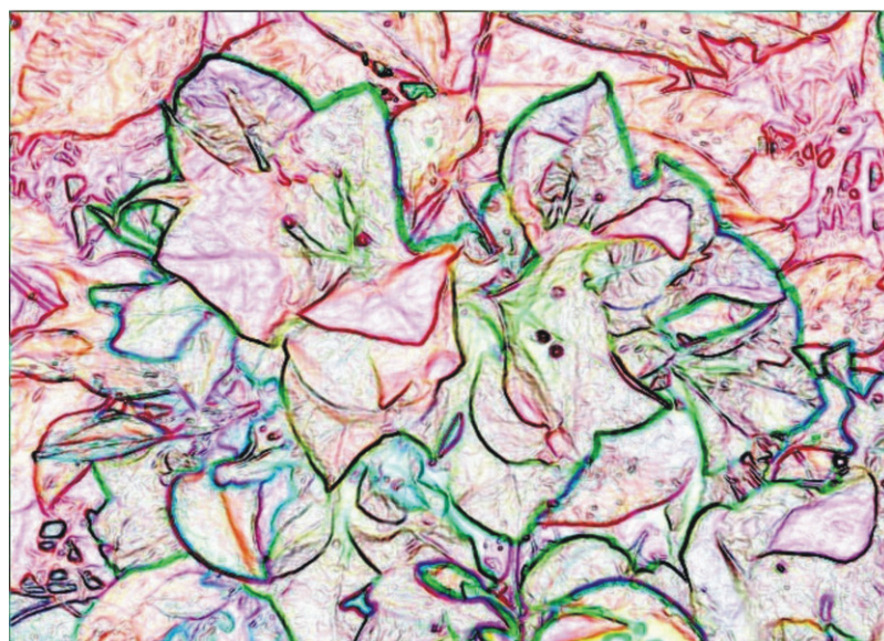
Figura 6. Detección de contornos en la imagen digital mostrada en la figura 3 | © Ernesto Bribiesca.
