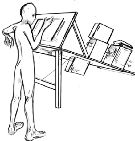
Fig. 2. Erika Karina Jiménez y Armando Vergara, Uso del rotoscopio , ilustración, © 2013. El animador dibuja sobre un caballete transparente, en cuyo reverso se proyecta, fotograma a fotograma, la película filmada. Esta imagen está basada en la ilustración que utilizó Max Fleisher para la patente.
