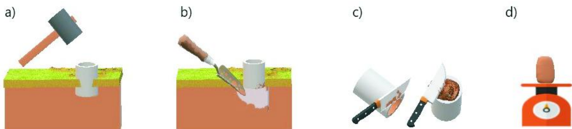
Figura 1. Método del cilindro para determinar la densidad aparente. (a) Enterrar un cilindro en el suelo de volumen conocido, (b) extraerlo con la ayuda de una pala o espátula, (c) limpiar el exceso de suelo, (d) pesar el suelo.
