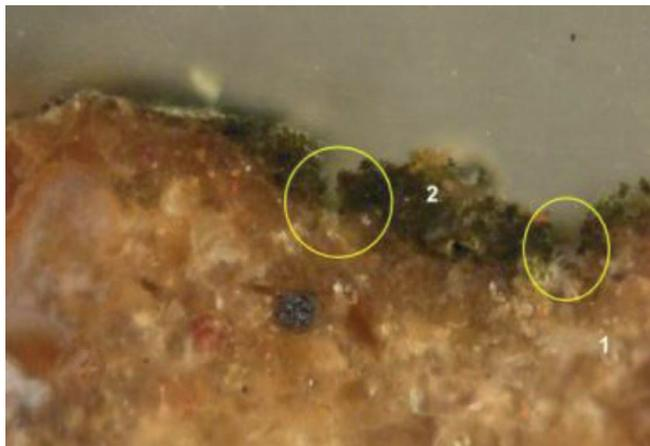
A.26. Muestra 9. Muestra de toba con inclusión verde, compuesta por dos capas: la capa 2 es una colonia de cianobacterias; en la capa 1 se observa *pitting* (agujeros).
