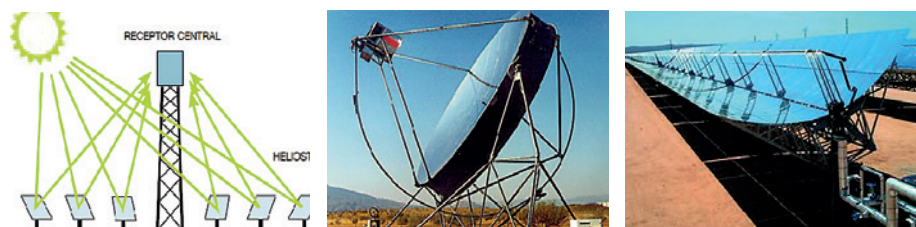
Figura 7.8. De izquierda a derecha: sistemas de receptor (torre) central, disco parabólico y concentradores parabólicos compuestos.
