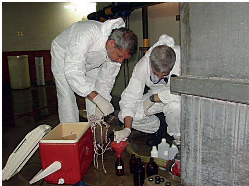
Figura 19. Inspectores realizan control de vuelcos en industrias. Toma de muestra. ACUMAR.
