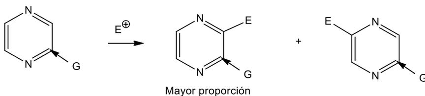
Si se activa la pirazina formando el *N*-óxido de la pirazina con un perácido, se puede realizar sobre éste la  $S_EAr$  y posteriormente remover el átomo de oxígeno activante con un haluro de fósforo(III).
