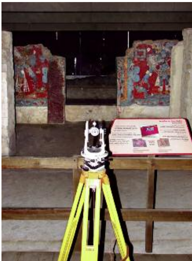
Figura 2.7. Medición de la orientación del eje de simetría de la fachada del Edificio A de Cacaxtla. (Foto: J. Galindo, 2008.)
