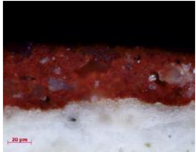
Figura 3.25. Fotografía al MO del pigmento rojo de repinte, magnificación 50X. Se observa un color diferente e inclusiones de minerales duros que no fueron pulverizados. (Foto: D. Magaloni y A. Paz, 2011.)
