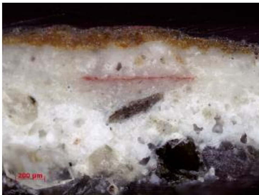
Figura 3.22. Fotografía al MO del mural norte del pórtico del Edificio A, magnificación 5X. Se muestra la doble estratigrafía. Por debajo de la actual pintura hubo otro enlucido y otra capa pictórica de color rojo que se raspó antes de aplicar la pintura actual. En la foto se aprecia la delgada capa roja que alguna vez fue la capa pictórica de una etapa anterior. (Foto: D. Magaloni y A. Paz, 2009.)
