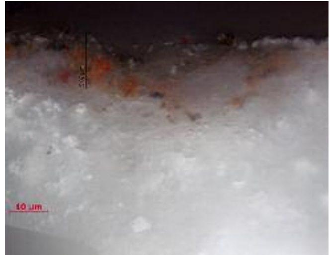
Figura 3.42. Fotografía al MO de color café oscuro de la piel del personaje 10E, guerrero vencedor, muro este, magnificación 100X. La capa extremadamente delgada muestra cómo se hizo este color al mezclar los pigmentos minerales rojos con negro de carbón. (Foto: D. Magaloni, 2011.)
