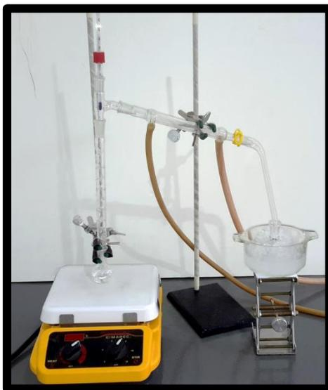
Fig. 3 Equipo de destilación fraccionada
