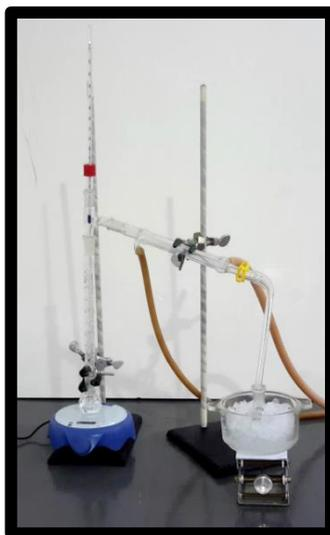
**Fig. 2** Equipo de destilación fraccionada
