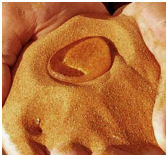
Figura 17. Arena hidrofóbica empleada en el suelo desértico para beneficio de los cultivos locales.
