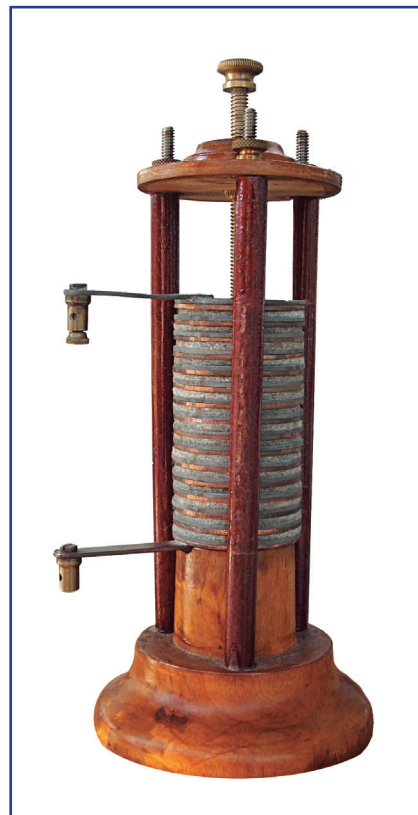
Reproducción de la pila de Volta donde pueden identificarse los discos de cobre y de zinc.
