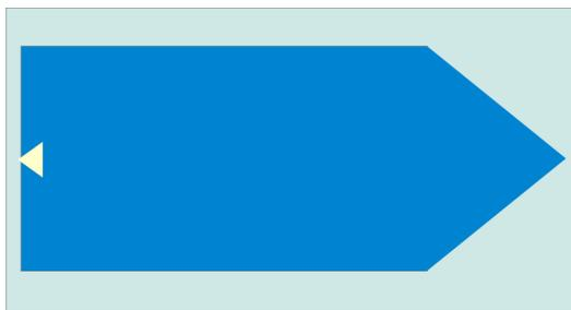
Figura 2. La lancha se hace con una tarjeta de presentación plástica o con alguna lámina de plástico que flote. El largo de la lancha debe ser de 4 a 5 cm y el ancho de unos 2.5 cm. Es importante que la base del pequeño hueco triangular esté orientada como se ve y solamente exista una muy pequeña abertura.
