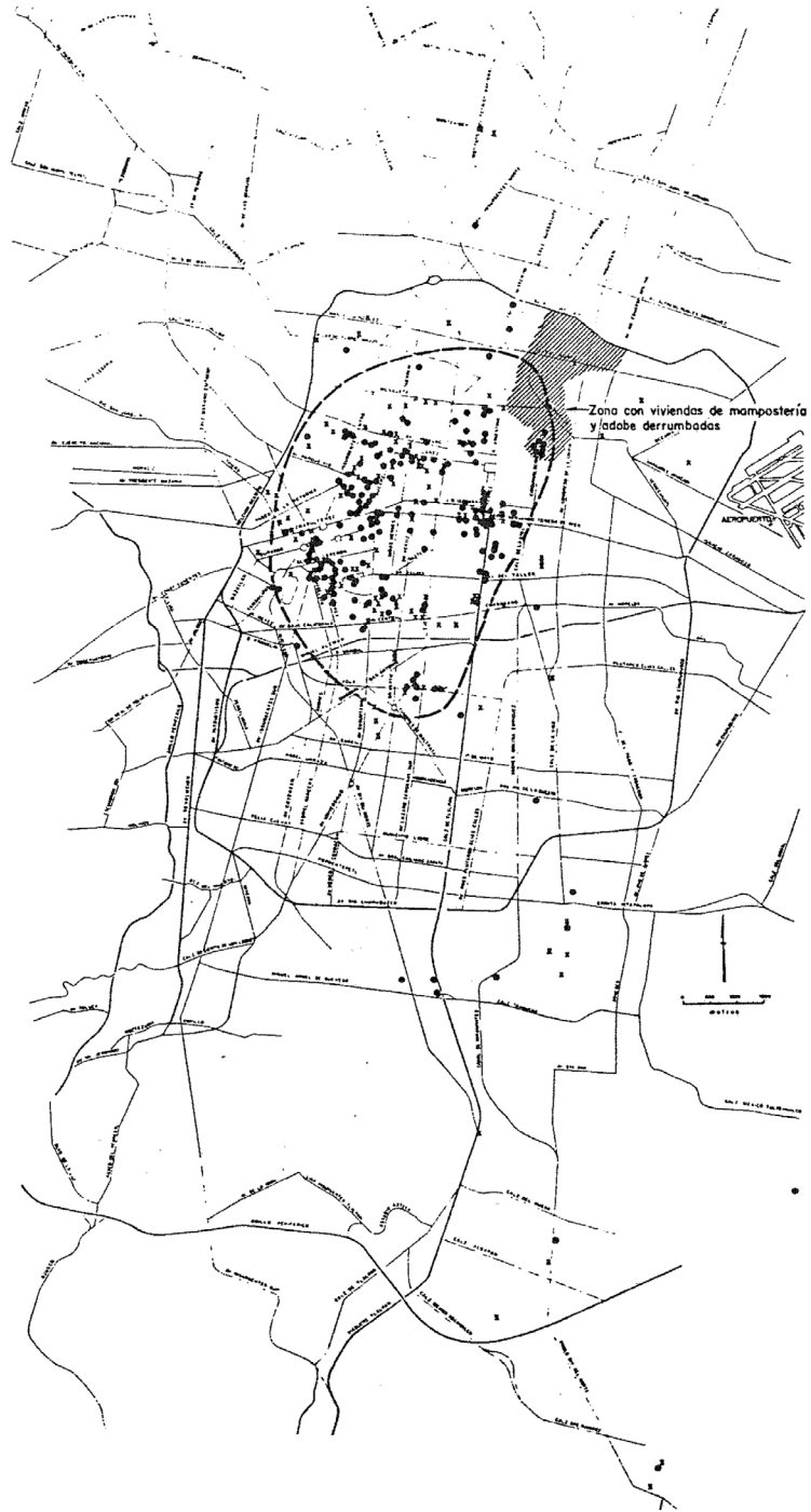
Figura 2. Ubicación de construcciones que sufrieron daño grave o colapso.
