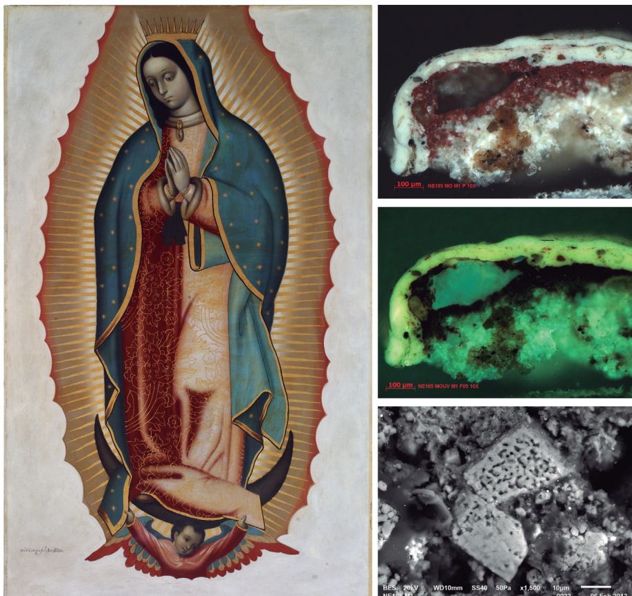
Figura 3. Este cuadro de Miguel Cabrera es uno de los pocos ejemplos que aún conservan todas sus características originales. En las microfotografías de una sección transversal de la pintura se aprecia la sucesión de capas. En la imprimación que sirve para sellar la textura de la tela se identificó un material calcáreo constituido por microfósiles de algas marinas cuya morfología cúbica es fácilmente distinguible en la imagen de electrones retrodispersados (MEB). Miguel Cabrera, La Virgen de Guadalupe , 1756, óleo sobre tela, 174 x 108 cm. Retablo de la Virgen de Guadalupe, iglesia de Tepotzotlán, Estado de México. Fotografía: Eumelia Hernández, 2012 DR© LDOA, IIE-UNAM.
