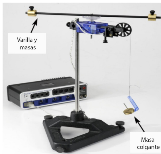
Figura 20.1: Equipo completo donde se muestra que la masa que cuelga aplica una torca al eje del sensor de giro y genera la aceleración angular resultante.
