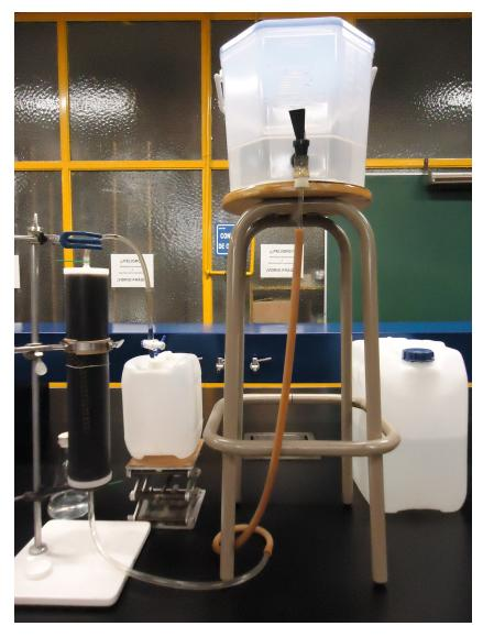
Sistema de desmineralización de H<sub>2</sub>O(l)
