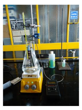
Arreglo experimental para la medición de pH<sup>+</sup>
