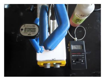
Calibración del pHmetro ( $\theta = 25.0$ °C, pH<sup>+</sup>= 04.00)
