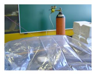
Bolsa de guantes para atmósferas inertes a ser utilizada
