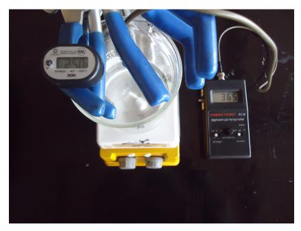
El pH+ (=pK<sub>a</sub>) de la disolución construida a  $\theta=25.0^{\circ}.$
