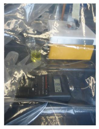
Medición del pH+ del  $H_2O(l)$  desmineralizada y desgasificada (pH+=8.12)
