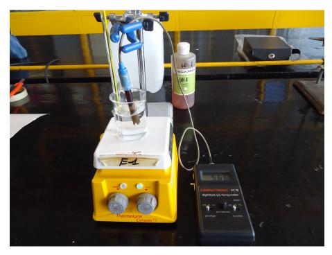
Arreglo experimental para la medición de  $\mathrm{pH^+}$
