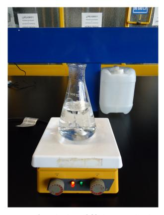
Desgasificación de  $H_2O(l)$  desmineralizada
