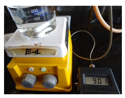
Medición del pH<sup>+</sup> de la disolución
