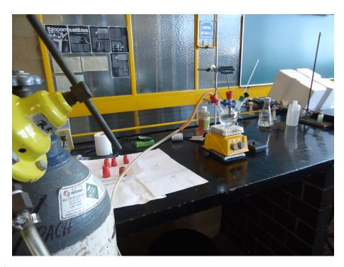
Arreglo experimental para el estudio del pH de la disolución preparada
