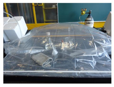
Bolsa de guantes para la construcción de la disolución acuosa bajo atmósfera de  $N_2(g)$
