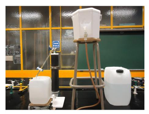
Sistema de desmineralización de H<sub>2</sub>O(l) monodestilada
