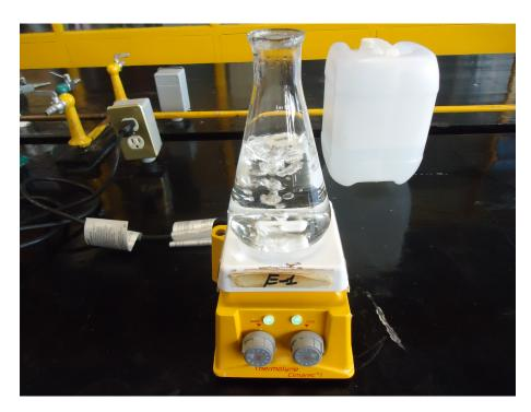
Desgasificación del  $\mathrm{H}_2\mathrm{O}(l)$  desmineralizada
