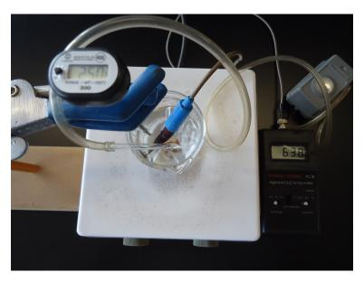
Medición de pH+ de H<sub>2</sub>O(l) saturada de CO<sub>2</sub>(g) (pH+=6.38)
