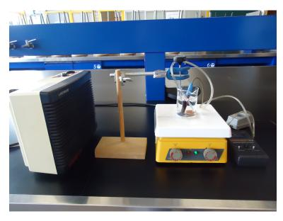
Inyección de aire atmosférico para la saturación con  $\mathrm{CO}_2(\mathbf{g})$  de  $\mathrm{H}_2\mathrm{O}(\mathbf{l})$
