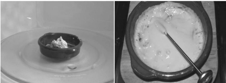
**Fig. 11.4.** Se puede fundir nuevamente la goma, por 50 segundos máximo y a 50°C.
