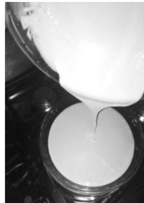
**Fig. 6.6.** Vertido de la espuma en el molde previamente preparado.
