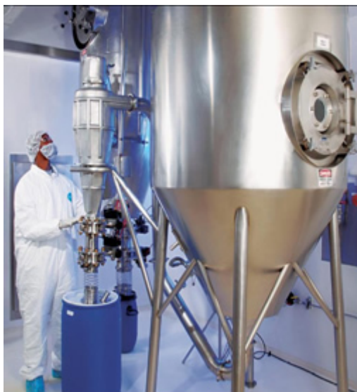
Equipos de lecho fluido: Pharma ISP
