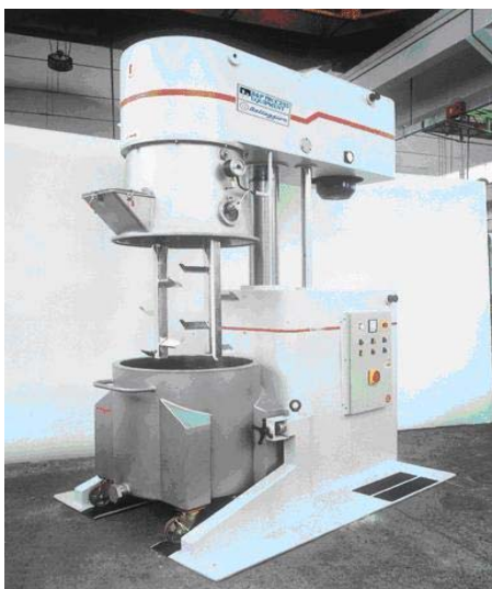
Mezclador planetario (B&PProcess)
