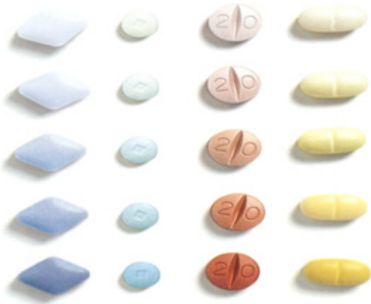
Etapas en el recubrimiento de tabletas (Glatt)
