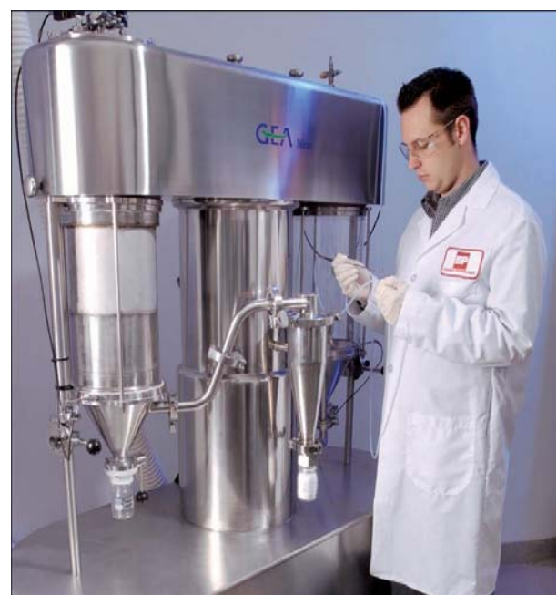
Secador de lecho fluido Gea Niro
