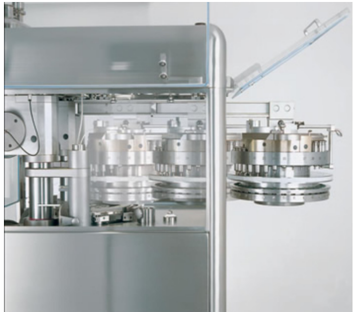
Modulo de compresión intercambiable(ECM) Cortesía Rash GEA- Courtoy
