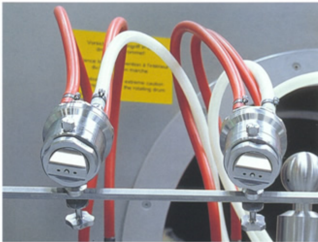
Boquillas para film coating y para recubrimiento de azúcar cortesía de Glatt
