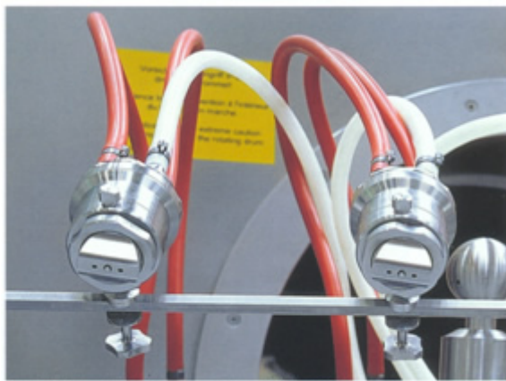
Pistolas de recubrimiento (Glatt)
