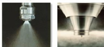
Atomización por boquilla y rotacional
