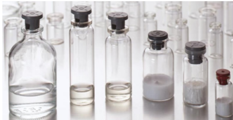
Aspecto de los viales a diferentes tiempos del proceso de liofilización
