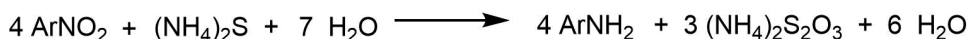
Esquema 5.118 Reacción balanceada en la reducción de nitrobeneno con sulfuro de amonio.
