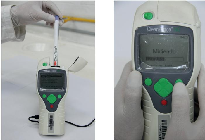
**Figura 16.5** Introducción y lectura del hisopo 3M™ CleanTrace™ al Luminómetro.
