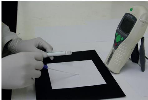
**Figura 16.3** Muestreo de la plantilla colocada sobre la superficie de análisis con el hisopo de 3M™ CleanTrace™.
