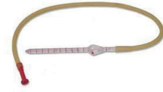
Figura 9.1 Pipeta de Thoma para aspiración de la muestra.
