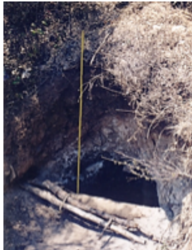
Figura 11. Pozo de agua dulce excavado en el fondo de una cárcava en Roaguía, y cuyo nivel freático se encontraba a 1.5 m de la superficie en el mes de mayo, al final de la temporada seca (Flores, 2003)
